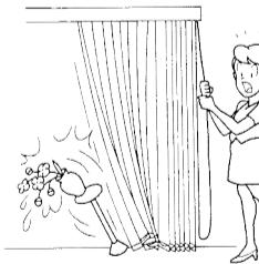
コード操作の場合、ドライブコードはまっすぐ下に引いて操作してください。左右斜め方向に引くと、製品破損や故障の原因となる恐れがあります。
