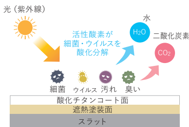
光触媒（酸化分解）のしくみ
